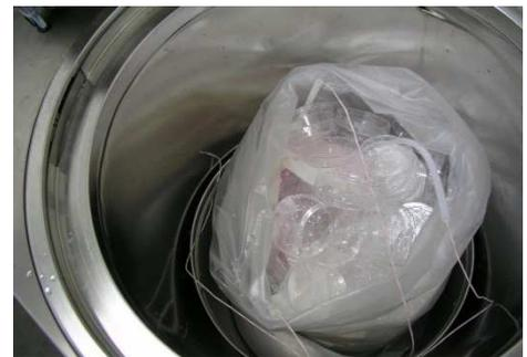
Fig 1. Esempio di carico di rifiuti all'interno di un sacco per sterilizzazione. È importante che il vapore penetri in ogni punto
